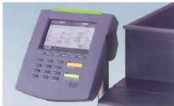
Panel de control LCD montado en el lateral de la máquina
